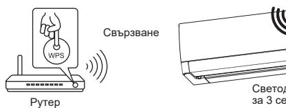
Светодиодната индикация светва за 3 секунди и след това премигва два пъти. При премигването на светодиодната индикация се чува звуков сигнал. Тази последователност от действия се повтаря.
